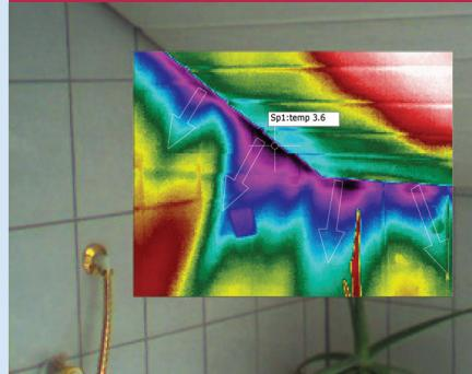
Sichtbarmachung von Kaltlufteinströmungen im Dach in Verbindung mit einer Unterdruckmessung.
